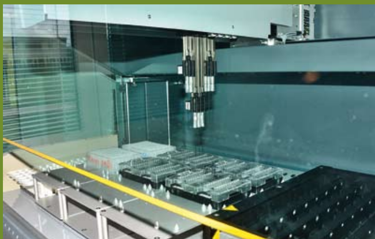
Nanášení hybridizované DNA na povrch čipů - MICROARRAYS
