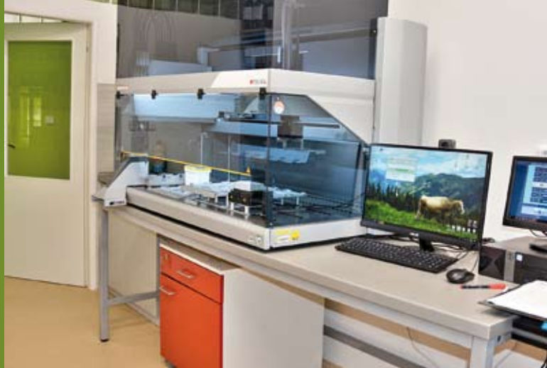
Automatická pipetovací stanice TECAN
